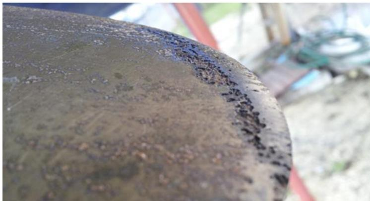
La cavitation affecte principalement les hélices de propulsion et turbines de pompes.
