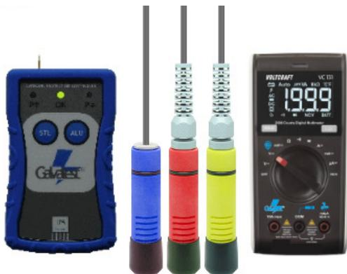
Les sondes plongeantes **Galvatest** permettent de déterminer la sensibilité à la corrosion de la coque (acier/alu) ou des équipements métalliques immergés de votre bateau (propulsion) et de réduire ainsi les coûts de maintenance associés.
